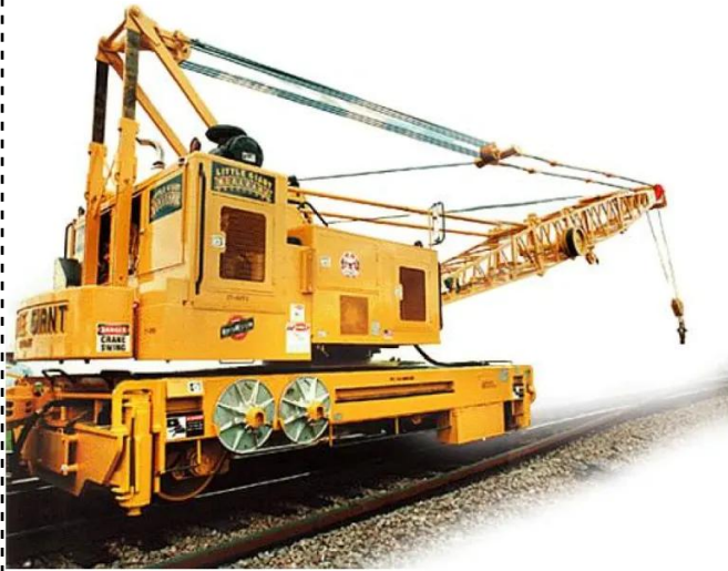
grue de chemin de fer
